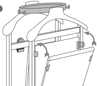
**IT**\_Per aprire il pannello stirapantaloni, spingere le alette (L) in plastica poste ai lati dello stesso. Per richiuderlo, spingerlo fino a chiusura completa.
